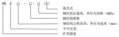
示例: SKZ22-1/1860(Z)表示公称直径为22mm, 钢丝抗拉强度不低于1860MPa的小涨壳式中空注浆矿用锚索。
